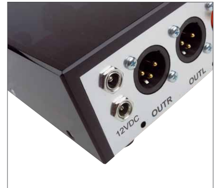
Einer der beiden 12-Volt-Anschlüsse dient zur Versorgung des DACs, der zweite für die Stromzufuhr zum X-SPDIF 2
