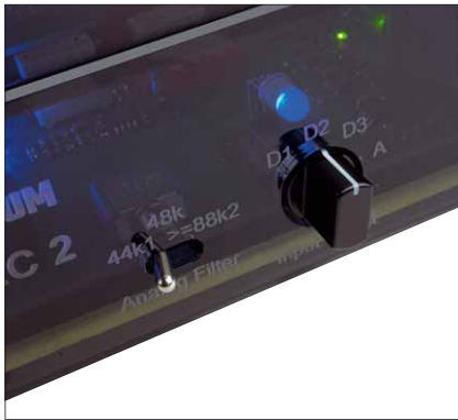
Der an der Front einstellbare Filter arbeitet analog und behebt ein generelles Problem der D/A-Wandlung auf clevere Weise
